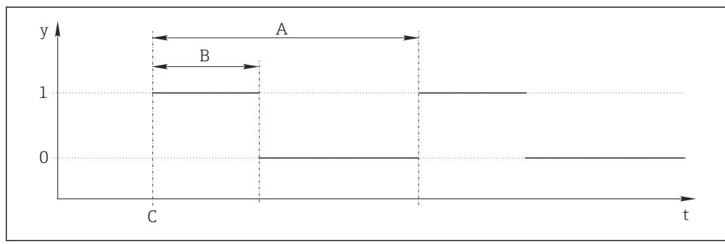
■ 60 Схема сигнала реле времени
