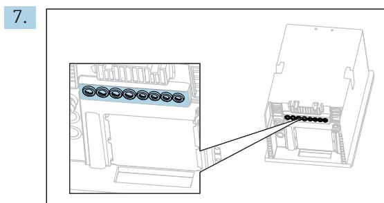
Пропустите кабели через кабельные уплотнения в нижней части прибора.
