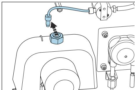
Ослабьте соединение шланга на отверстии в реакторе и вытяните шланг.
