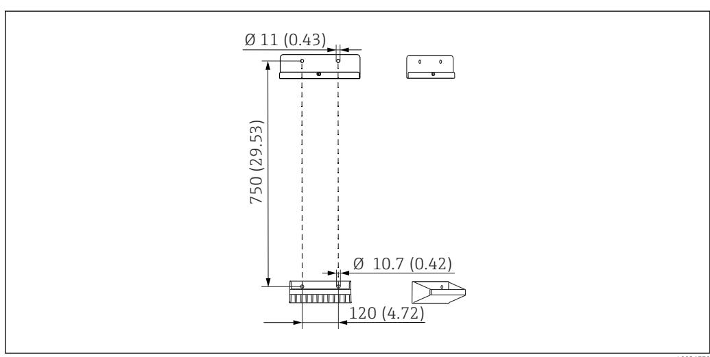
**14** Размеры блока держателя. Единица измерения – мм (дюйм)
