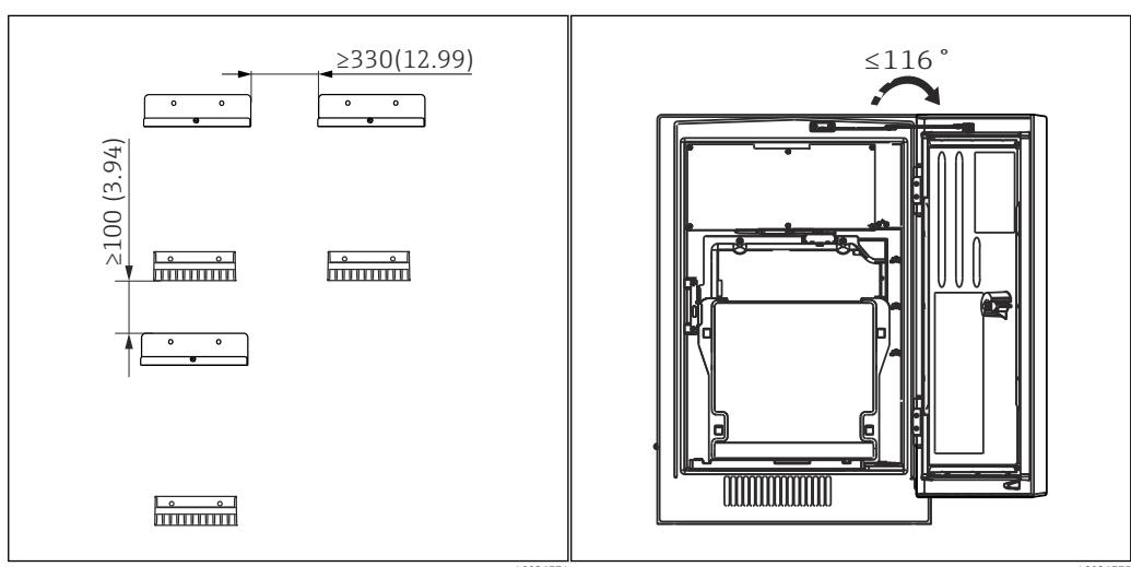
Требования в отношении зазоров при настенном монтаже
