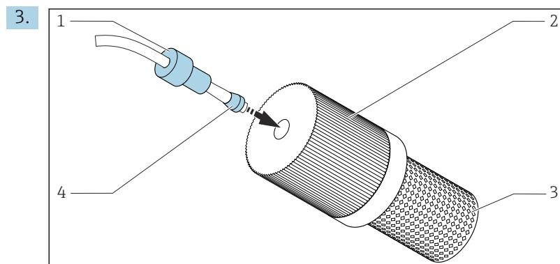
51 Установка погруженного фильтра (входит в комплект поставки) на пробоотборном шланге.
