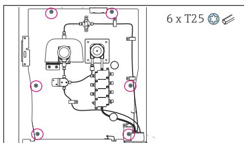
Выверните 6 винтов крепежной панели с помощью отвертки с наконечником Торх (T25).
