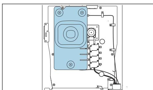
Выверните винты крепления крышки и снимите крышку.
