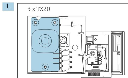
Ослабьте 3 винта с прорезью типа TORX (восьмигранник) на прозрачной крышке реактора.
