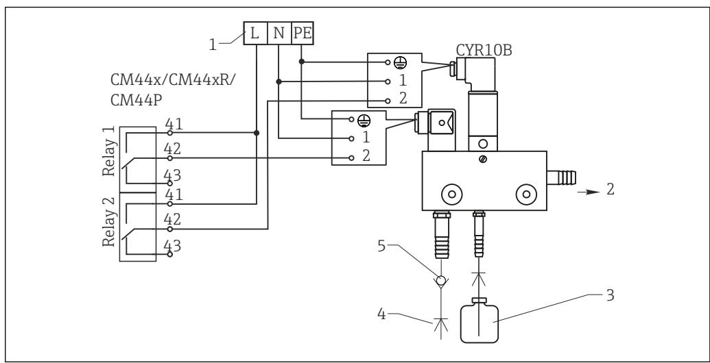
■ 34 Подключение блока очистки инжектора CYR10B
