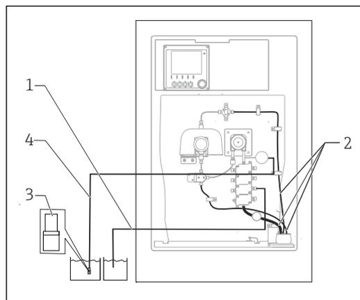
2 Sistema de medición con filtro de succión
