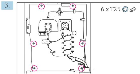
Afloje los 6 tornillos de la placa de soporte con un destornillador Torx (T25).
