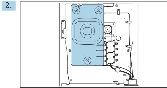
Afloje los tornillos de la cubierta y retire esta.
