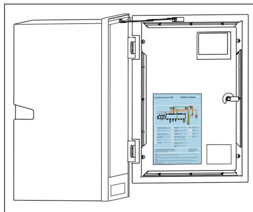
Los diagramas siguientes reflejan el estado en el momento de publicar esta documentación. El diagrama de conexiones de las mangueras válido para su versión de equipo está en la parte interior de la puerta del analizador.
