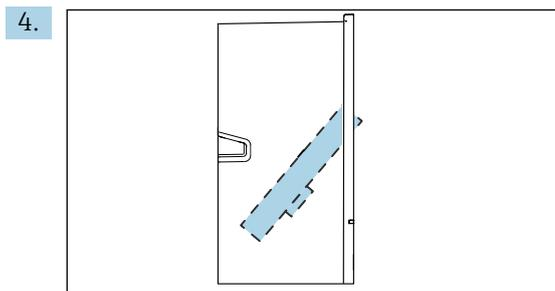
Despliegue la placa de soporte hacia la parte frontal .
