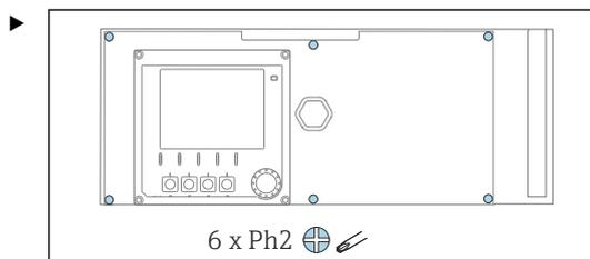
Afloje los 6 tornillos de la tapa del compartimento de la electrónica con un destornillador Phillips y abra la tapa hacia delante.
