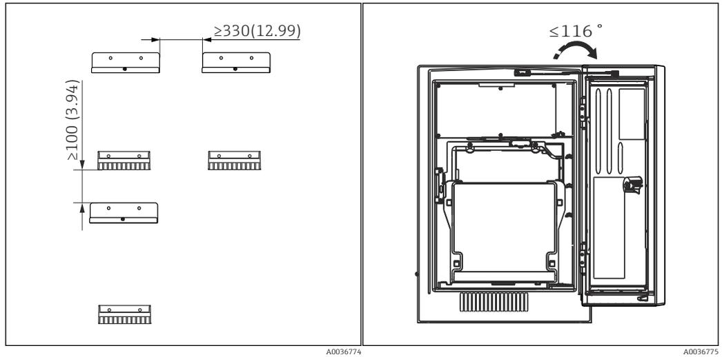
16 Espacio mínimo requerido para el montaje. 17 Ángulo de apertura máximo
