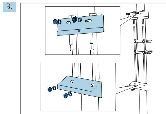
Смонтируйте настенный держатель (входит в комплект поставки анализатора) на фиксаторе стойки.
