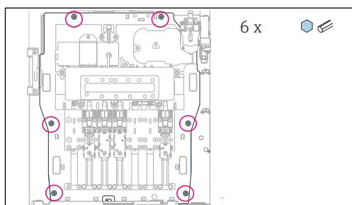
Выверните 6 винтов крепежной панели шестигранным ключом.
