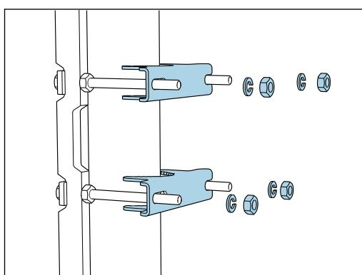
С другой стороны наденьте на стяжные болты вторую часть фиксатора,
