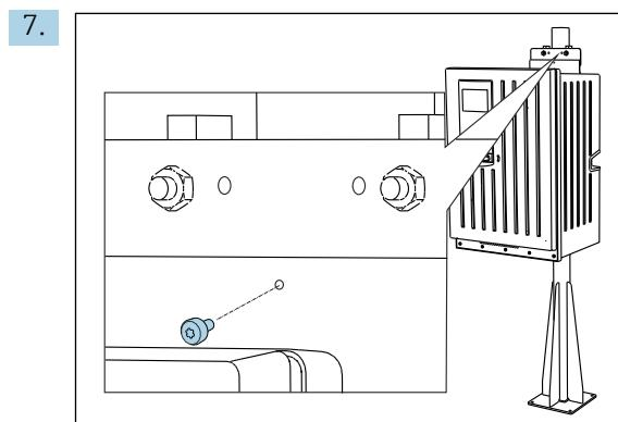
Зафиксируйте верхний стеновой держатель с помощью предлагающегося винта.
