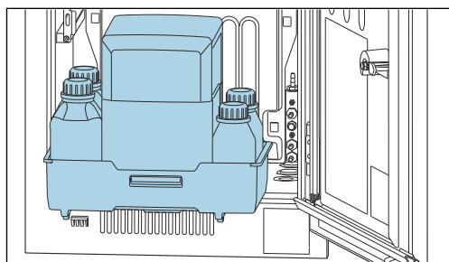
Снимите лоток для бутылей: слегка приподнимите утопленный захват и оттяните его вперед.
