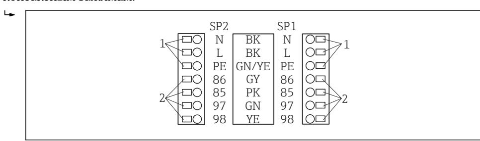
■ 31 Схема подключения для Liquiline System CAT820/860
