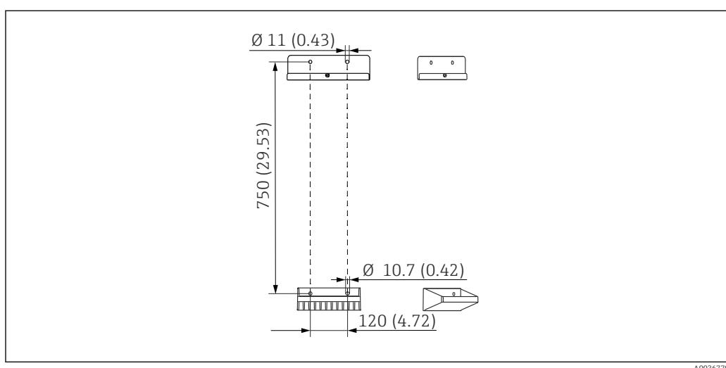
■ 19 Размеры блока держателя. Единица измерения – мм (дюйм)
