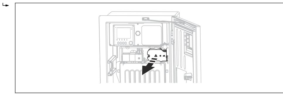
8. Проложите кабель внутри корпуса таким образом, чтобы **оголенный** экран кабеля попадал в один из кабельных зажимов и обеспечивалась простота прокладки жил кабеля вплоть до контактных зажимов.
