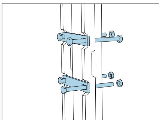
Вставьте стяжные болты в планку и через отверстия в стойке закрепите гайками.
