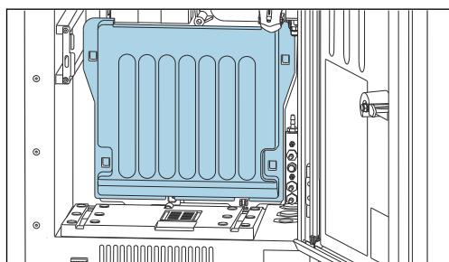
Снимите крышку, закрепленную крючками.
