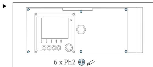
Отверткой с крестообразным наконечником выверните 6 винтов на крышке отсека электроники и разложите крышку вперед.
