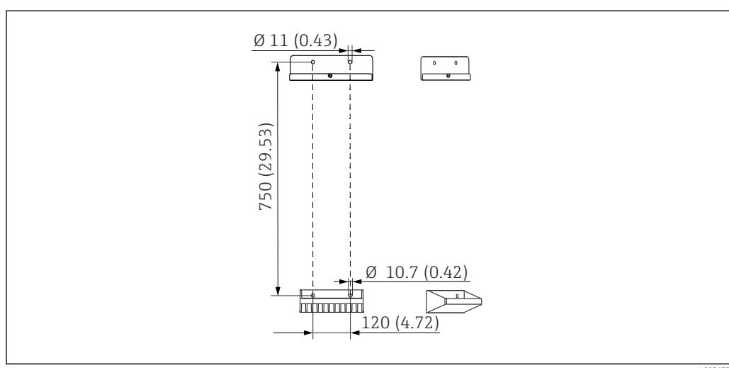
■ 12 Размеры блока держателя. Единица измерения – мм (дюйм)
