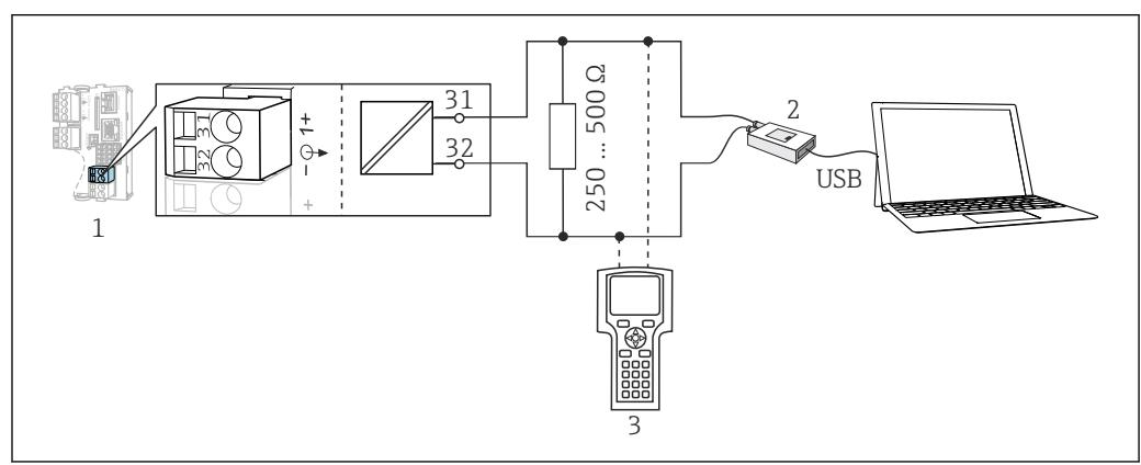
18 Передача данных по протоколу HART посредством модема
