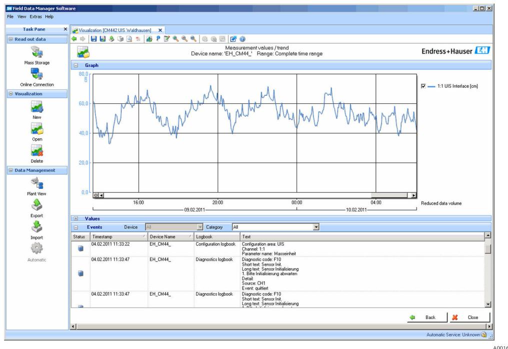
9 Field Data Manager: отображение кривых нагрузки
