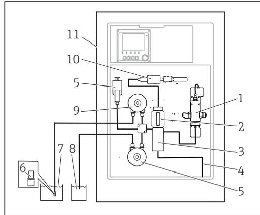
2 Sistema di misura con Liquiline System CA80COD e filtro di aspirazione
