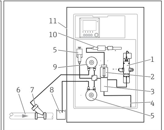
3 Sistema di misura con Liquiline System CA80COD e filtro a Y
