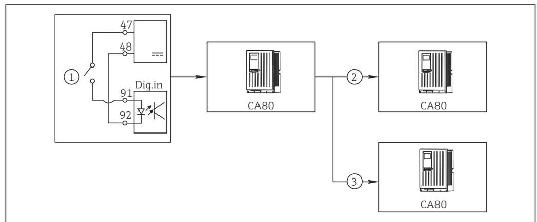
63 Exemple pour contrôle central du nettoyage
