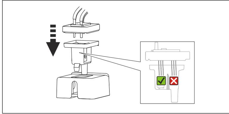
Replacer le couvercle en caoutchouc en veillant à ce que les capillaires se trouvent dans la chambre de mesure.
