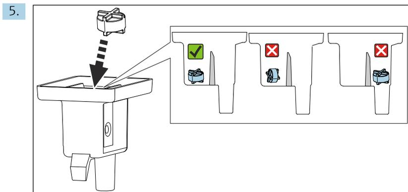
Placer l'agitateur magnétique dans la chambre de mesure en s'assurant qu'il est à plat et dans la chambre de mesure.
