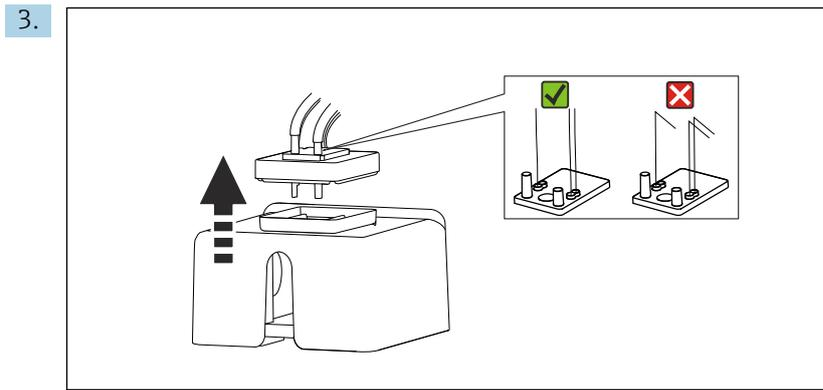
Soulever le couvercle en caoutchouc de la cuvette. Il ne doit pas y avoir de plis dans les capillaires au niveau du support de capillaire ou au niveau des vannes, et il ne faut pas retirer les capillaires du connecteur de tuyau.
