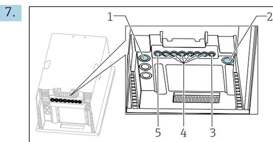
1 Tuyau d'évacuation de l'échantillon "D" et tuyau d'arrivée de l'échantillon SP1 et SP2 (version 1/2 voies) ou SPx (version 4/6 voies)
