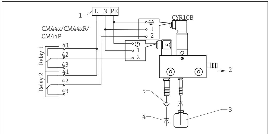
44 Raccordement de l'unité de nettoyage à injecteur CYR10B
