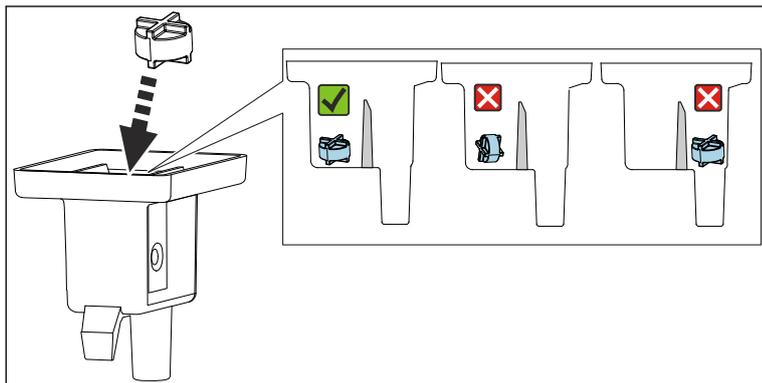
Replacer l'agitateur magnétique dans la chambre de mesure en s'assurant qu'il est à plat et bien à l'intérieur de la chambre de mesure.
