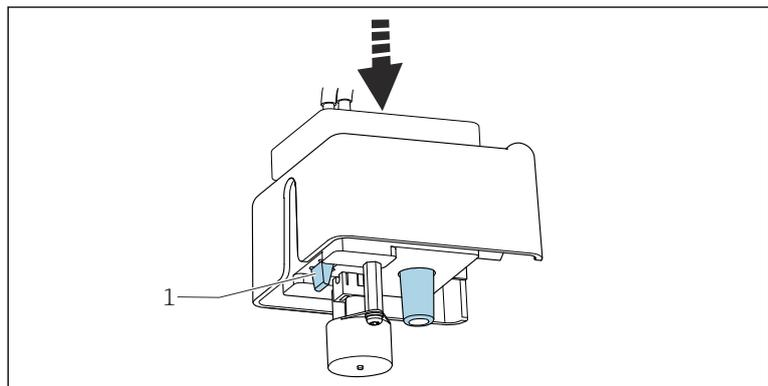
Pousser la cuvette avec l'agitateur magnétique et le couvercle dans le support. S'assurer que la languette (1) s'enclenche.
