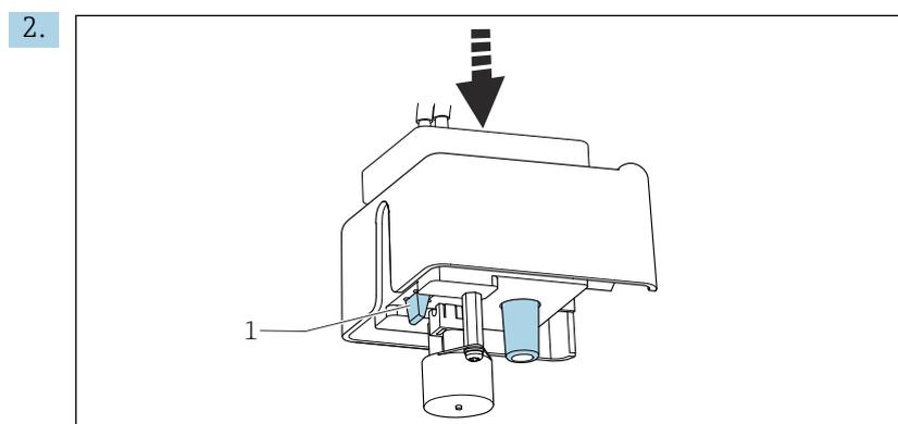
Engager la cuvette avec l'agitateur magnétique et le couvercle dans le support. S'assurer que la languette (1) s'enclenche.
