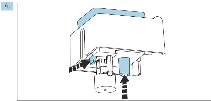
Faire sortir la cuvette par le bas en appuyant simultanément sur la languette et l'attache du tuyau.
