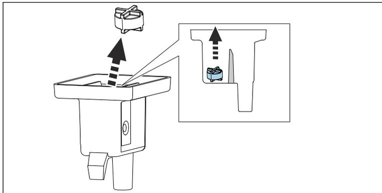
Retirer l'agitateur magnétique de la chambre de mesure.
