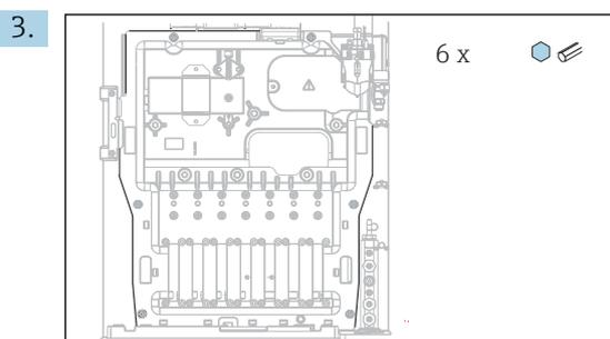
Dévisser les 6 vis sur la plaque porteuse à l'aide d'un tournevis Torx (T25).
