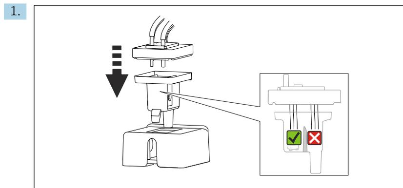
Replacer le couvercle en caoutchouc de la cuvette et veiller à ce que tous les capillaires se trouvent dans la chambre de mesure.
