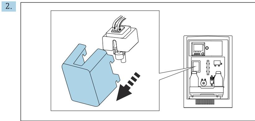
Retirer le couvercle à l'avant de la cuvette.
