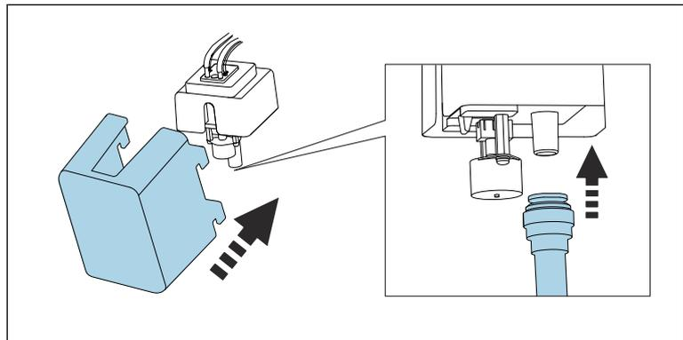
Raccorder à nouveau le tuyau de sortie "W" et refixer le couvercle.
