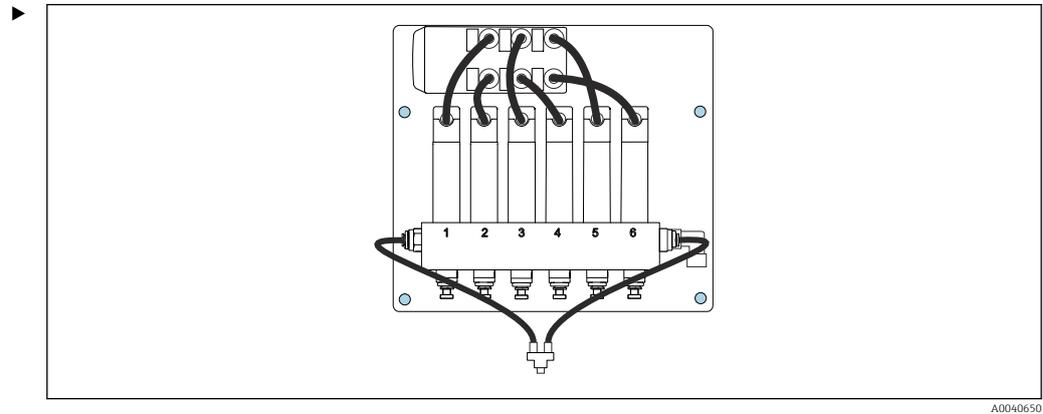
Monter la platine au moyen des trous de montage (en bleu).
