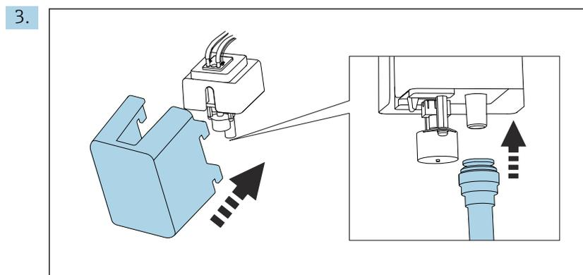
Raccorder de nouveau le tuyau d'évacuation "W" et fixer de nouveau le couvercle.
