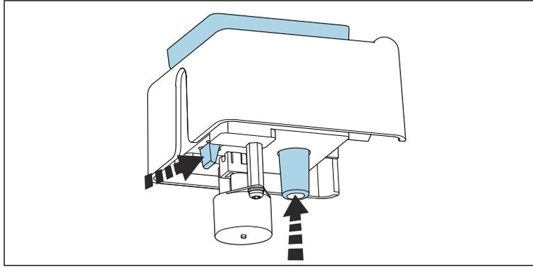
Faire sortir la cuvette par le bas en appuyant simultanément sur la languette et l'attache du tuyau.
