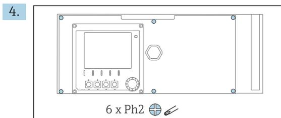
Solte os 6 parafusos na tampa do compartimento de componentes eletrônicos usando uma chave Phillips e dobre a tampa para a frente.
