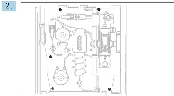
Solte os 5 parafusos no quadro da portadora usando uma chave de fenda Torx (T25).
