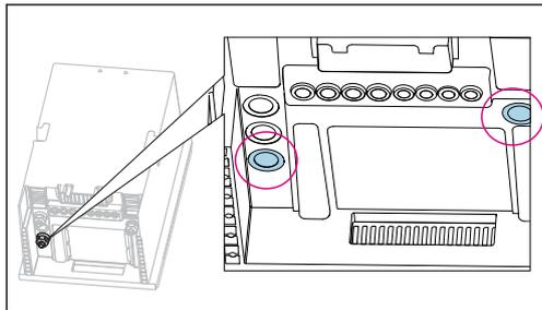
Guie a mangueira de resíduos aquecida (à esquerda no gráfico) e a mangueira de amostra aquecida (à direita no gráfico) através dos prensa-cabos indicados.
