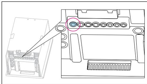
Guie o cabo da fonte de alimentação, o qual é providenciado pelo cliente no local da instalação, através do prensa-cabos indicado.
