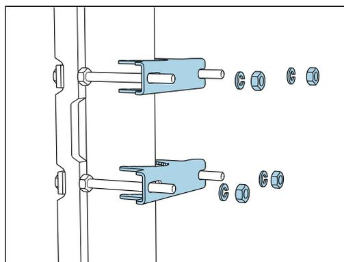
Encaixe as contraporcas e aperte o retentor em poste usando arruelas de pressão e porcas.
