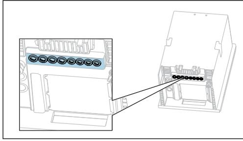
Guie os cabos pelo prensa-cabos na base do equipamento.
