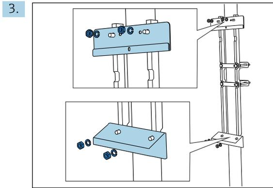
Instale a unidade de suporte de parede (incluída na entrega com o analisador) no retentor em poste.
