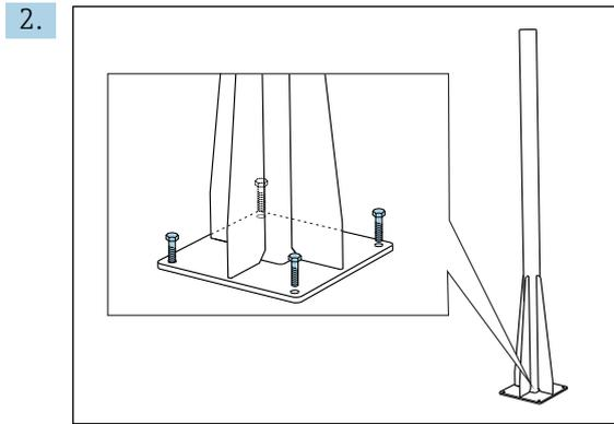
Erga o poste e instale-o com segurança na fundação usando 4 parafusos de fixação (a serem providenciados pelo cliente. <sup>1)</sup>).
