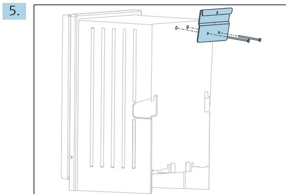
Aparafuse o suporte de suspensão da unidade de suporte de parede (incluído na entrega com o analisador) no analisador.
