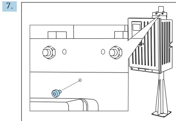
Fixe a unidade de suporte de parede no lugar com o parafuso providenciado.
