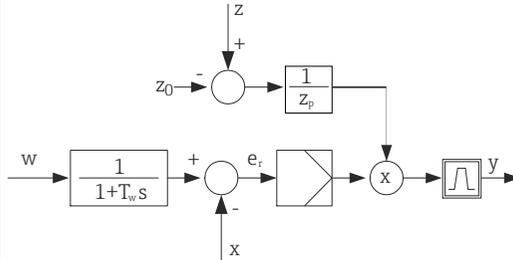
La régulation prédictive est à proprement parler une commande, car son effet n'est pas mesuré directement. Cela signifie que le flux d'alimentation est dirigé exclusivement vers l'avant. D'où la désignation anglaise "feedforward control".
