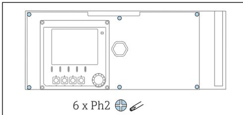
Dévisser les 6 vis du couvercle du compartiment de l'électronique à l'aide d'un tournevis cruciforme et rabattre le couvercle vers l'avant.
