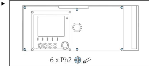
Dévisser les 6 vis du couvercle du compartiment de l'électronique à l'aide d'un tournevis cruciforme et rabattre le couvercle vers l'avant.
