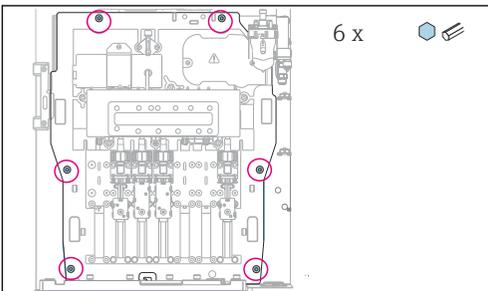
Dévisser les 6 vis de la plaque porteuse à l'aide d'une clé Allen.
