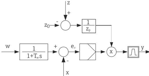
Estritamente falando, o controle feedforward envolve um sistema de controle de ciclo aberto, já que seu efeito não é medido diretamente. Isto significa que a vazão de alimentação é direcionada exclusivamente para frente. Por isso a designação "controle feedforward".
