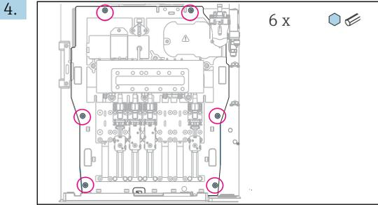
Solte os 6 parafusos da placa portadora usando uma chave Allen.
