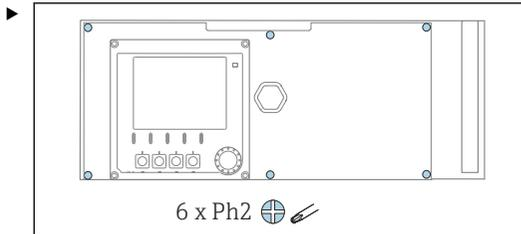
Solte os 6 parafusos na tampa do compartimento de componentes eletrônicos usando uma chave Phillips e dobre a tampa para a frente.
