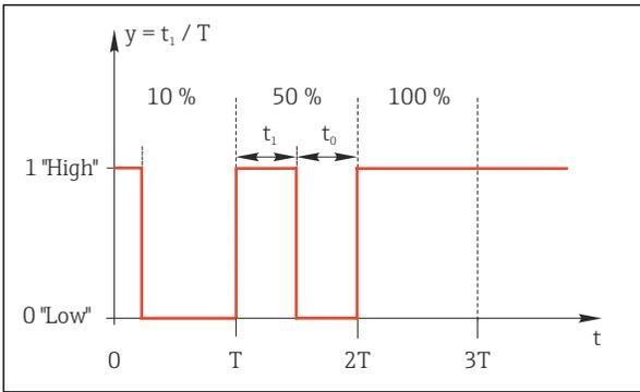
64 Aplicação típica: válvula solenoide
