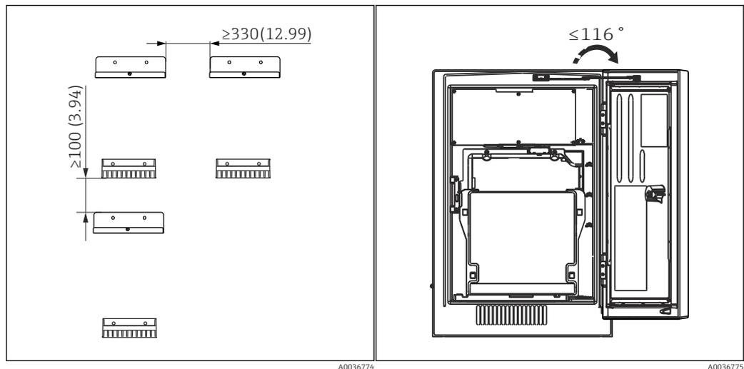
12 *Espaçamento mínimo necessário para montagem. Unidade de engenharia mm (pol.).*
