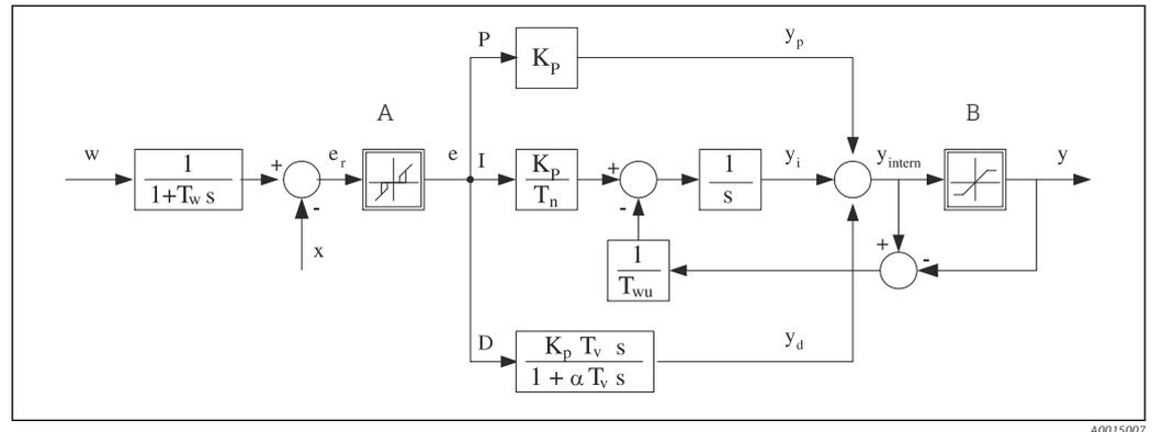
62 Diagrama em blocos da estrutura do controlador
