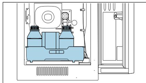
Remova a bandeja da garrafa: Eleve o cabo encaixado levemente e empurre-o para a frente.
