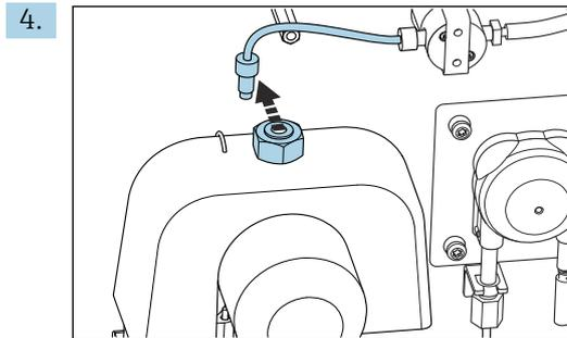
Afrouxe a conexão da mangueira na abertura do reator e retire a mangueira.
