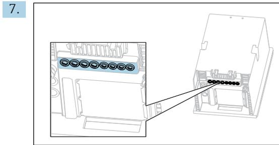
Guie os cabos pelo prensa-cabos na base do equipamento.
