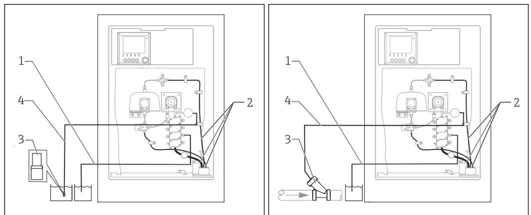
2 Sistema de medição com filtro de sucção
