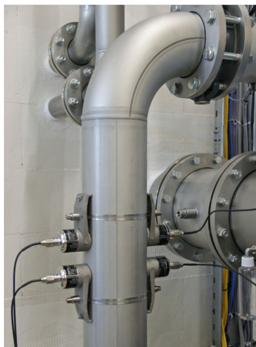
図 1：90°エルボの下流側に設置されたクランプオンセンサ
