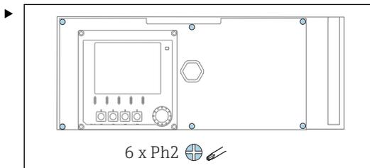
使用十字螺丝刀松开电子腔盖上的六颗螺丝，并向前叠起盖板。
