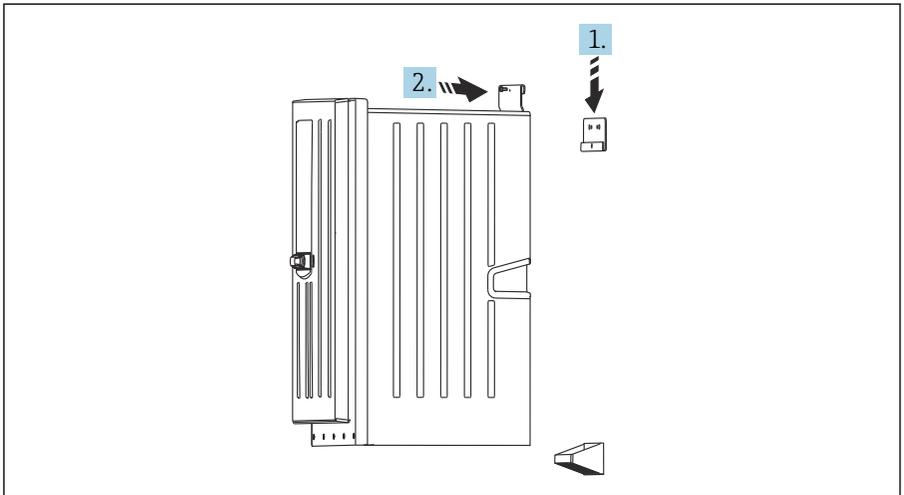
将分析仪固定在墙装架上（1）。
