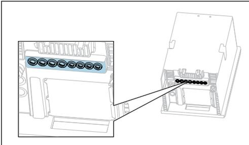
将电缆穿过设备底部的电缆缆塞。
