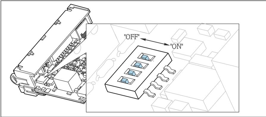
图 48 内部端接的 DIP 开关
