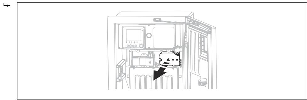
8. 在外壳内敷设电缆，使得裸露的电缆屏蔽线插入至其中一个电缆夹中，电缆线芯能够轻松连接至插入式接线端子。
