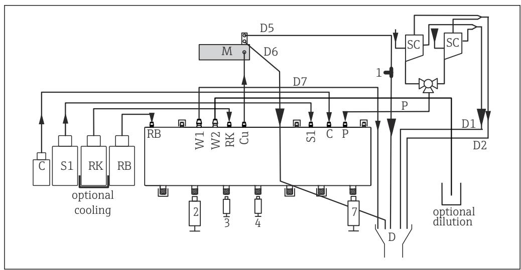
图 65 双通道型 Liquiline System CA80PH 分析仪 (钼蓝法)
