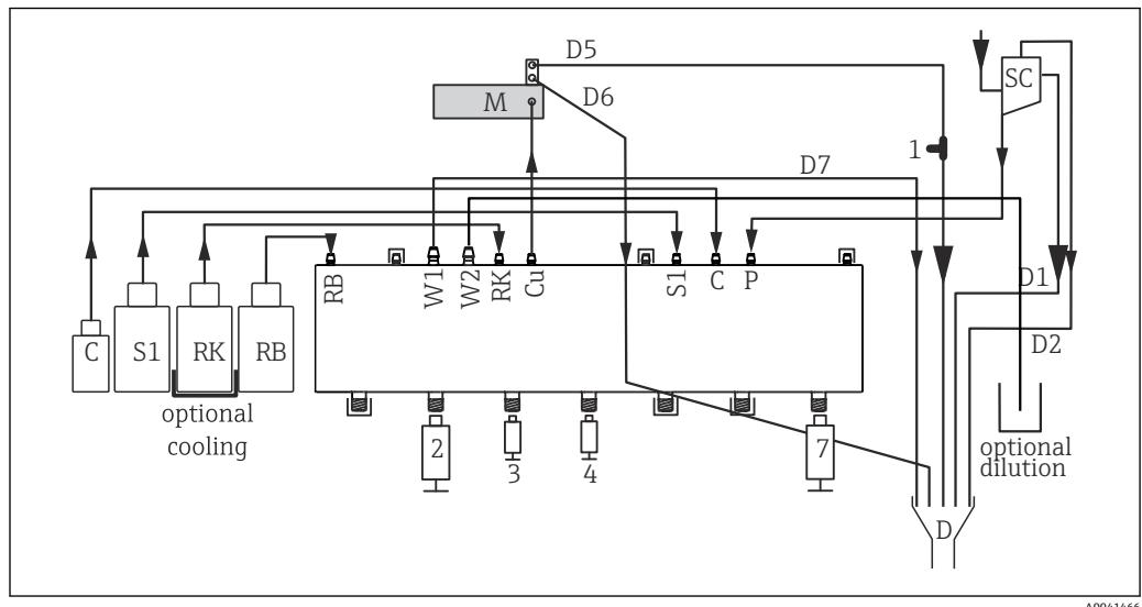
图 64 单通道型 Liquiline System CA80PH 分析仪 (钼蓝法)
