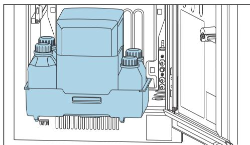
取出托盘：轻抬托盘底部凹槽，向前拉出托盘。
