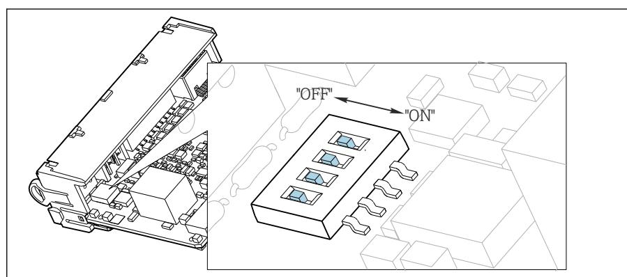
图 53 内部端接的 DIP 开关
