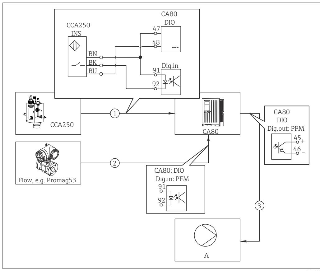
图 67 带前馈控制的余氯控制实例
