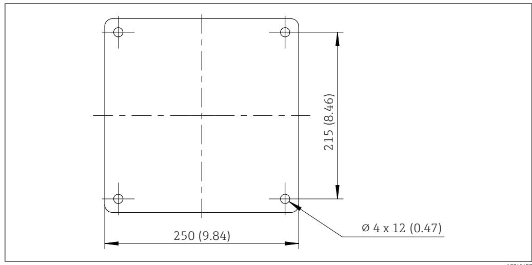
图 22 基础平面图；单位: mm (in)
