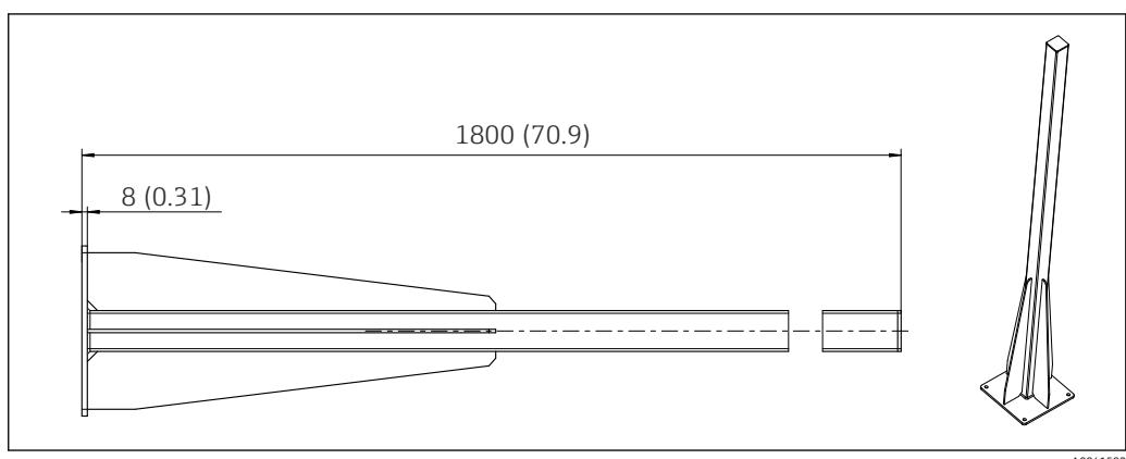
图 16 户外安装型分析仪安装立柱 (附件) 示意图; 单位: mm (in)
