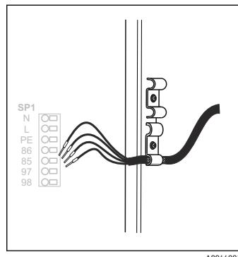
图 30 拧紧螺丝 (2 Nm)
