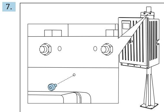
使用包装中的螺丝将上部墙挂支架固定到位。
