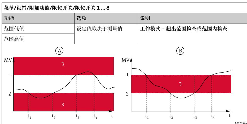
图 72 量程监控超出 (A)，在 (B) 内 (无迟滞和延迟时间)
