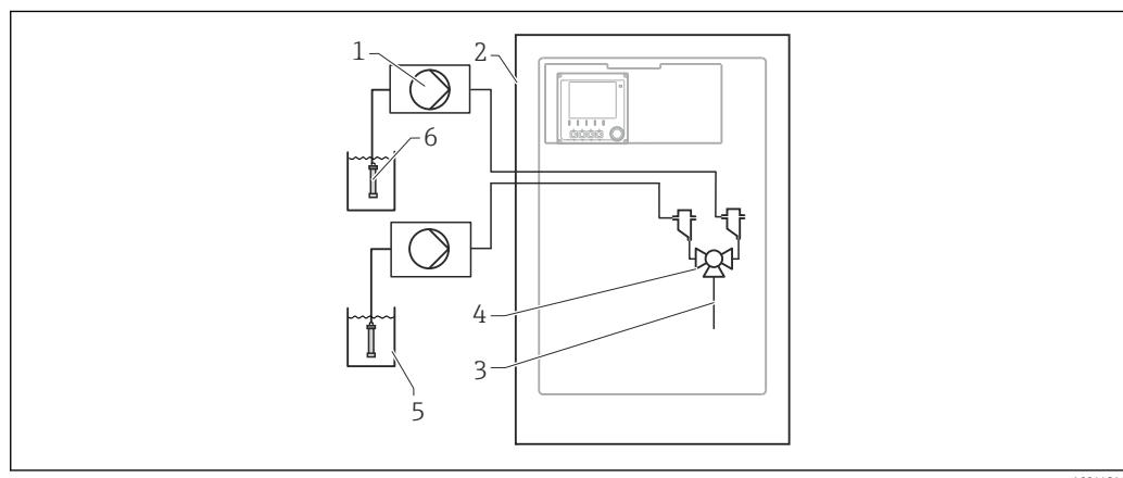
图 7 测量系统, 安装有 2 台 Liquiline System CAT820
