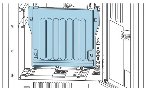
拆除安装就位的盖板。
