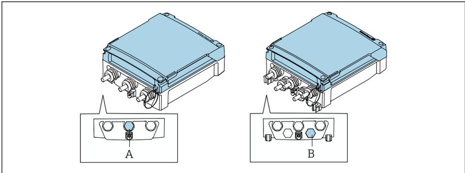
A Connettore per il sensore di pressione sulla custodia del trasmettitore compatto
