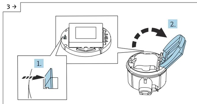
► Abra a tampa do portador dos componentes eletrônicos.
