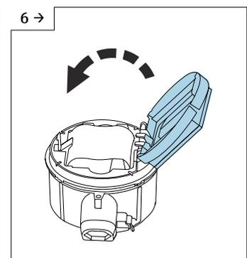
► Feche a tampa do portador dos componentes eletrônicos.
