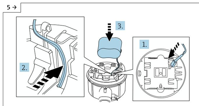
► Insira o plugue da bateria e coloque o cabo no recesso do portador da bateria, conforme mostrado na figura. Insira a bateria no compartimento da bateria.
