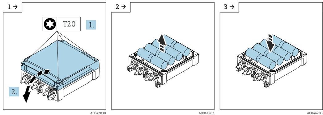
► Abra a tampa do compartimento de conexão.
