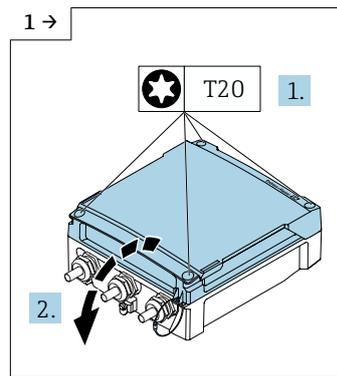
▶ Abra a tampa do compartimento de conexão.
