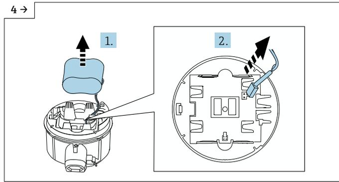
► Retire a bateria do compartimento da bateria (ela permanece no entanto conectada) e desconecte o conector da bateria.
