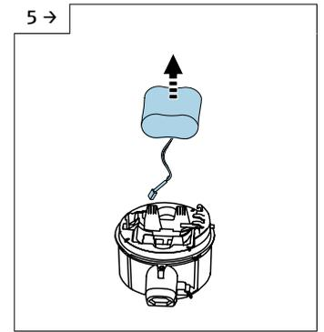
► Agora remova a bateria do compartimento da bateria completamente.
