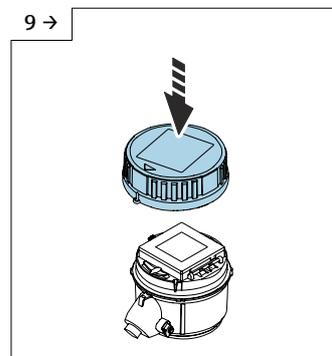
► Coloque a tampa no invólucro do transmissor.
