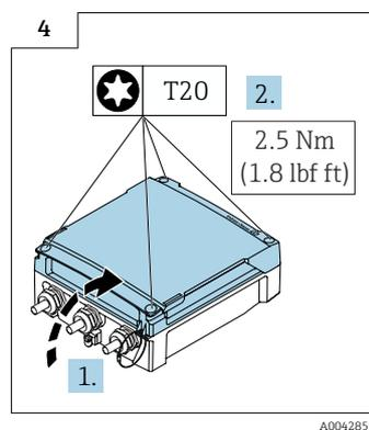
► Feche a tampa do compartimento de conexão.
