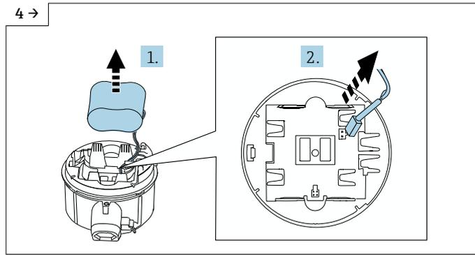
► Retire a bateria do compartimento (ela ainda está presa, no entanto) e desconecte o plugue da bateria.
