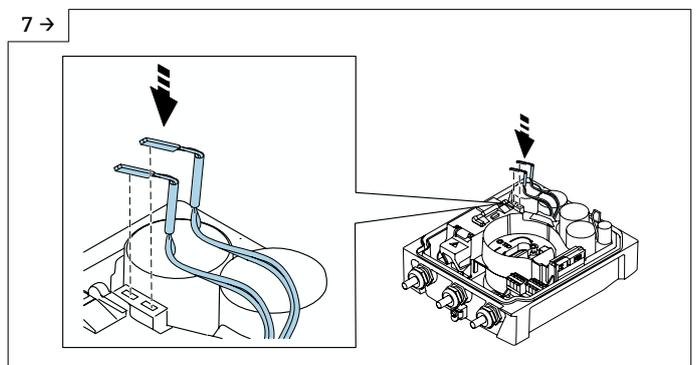
▶ Conecte o conector do novo pacote de bateria.
