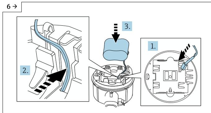
► Insira o conector da bateria e coloque o cabo no recesso do portador da bateria como mostrado na figura. Coloque a bateria no compartimento da bateria.
