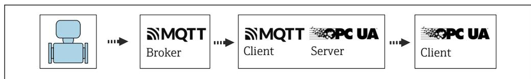
2 Conexión por radiotelefonía móvil a través de agente MQTT, servidor OPC-UA y cifrado TLS.
