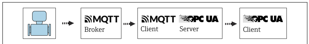
图 2 通过 MQTT 代理服务器、OPC-UA 服务器和 TLS 加密协议建立蜂窝无线电通信连接。
