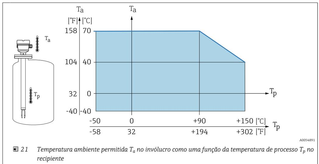
21 Temperatura ambiente permitida  $T_a$  no invólucro como uma função da temperatura de processo  $T_p$  no recipiente
