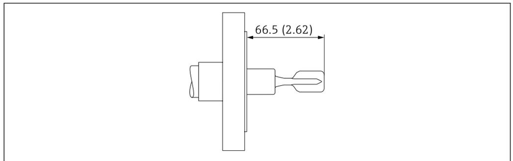
**34** 法兰连接型传感器示意图。测量单位 mm (in)
