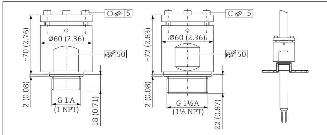
图 40 高压滑动套管。测量单位 mm (in)
