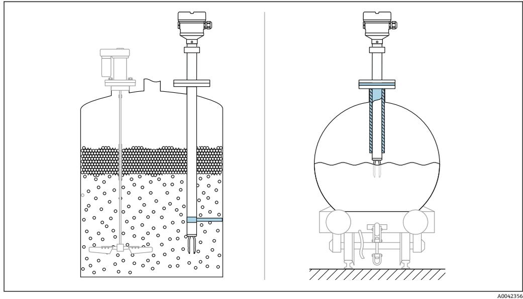
图 16 实例：存在动态负载时，应支撑设备
