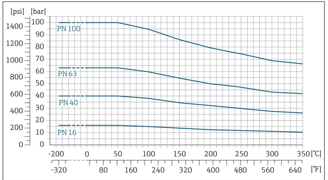
28 Mit Flanschwerkstoff 1.4404 (F316/F316L), Alloy C22
