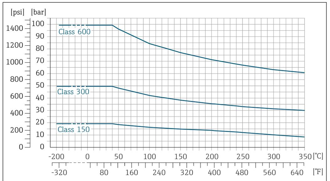
29 Mit Flanschwerkstoff 1.4404 (F316/F316L)
