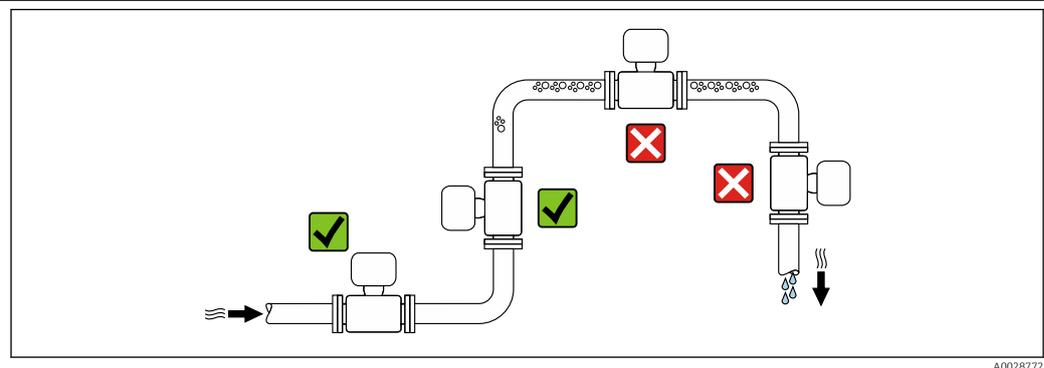
Um Messfehler aufgrund von Gasblasensammlungen im Messrohr zu vermeiden, folgende Einbauorte in der Rohrleitung vermeiden:
