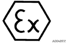
Рис. 6. Ярлык АТЕХ для использования во взрывоопасных зонах
