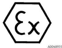
Рис. 3. Ярлык АТЕХ для использования во взрывоопасных зонах
