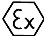
Figura 6. Etiqueta "ATEX" para uso en zonas con peligro de explosión
