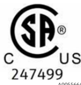
Figura 5. Etiqueta que indica que el equipo está homologado para el uso en zonas con peligro de explosión en Estados Unidos y en Canadá
