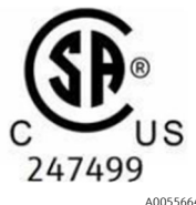
Figura 5. Etichetta che indica che l'apparecchiatura è approvata per l'uso in aree pericolose in Stati Uniti e Canada
