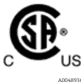
Рис. 4. Маркировка CSA для использования во взрывоопасных зонах в США и Канаде
