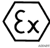
Рис. 6. Ярлык АТЕХ для использования во взрывоопасных зонах
