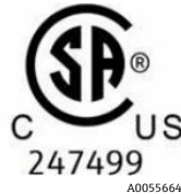
图 5. 此认证标志表示设备允许在美国和加拿大的防爆场合中使用
