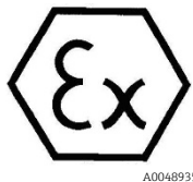
Figura 3. Etichetta ATEX per impiego in aree a rischio d'esplosione
