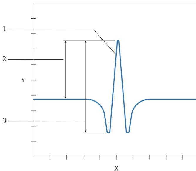
Figura 3. Segnale semplice normalizzato  $2f$ ; concentrazione di analita proporzionale all'altezza del picco o all'altezza picco-picco, in base all'algoritmo usato
