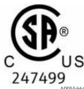
Figura 5. Etiqueta que mostra que o equipamento está aprovado para uso em áreas classificadas nos Estados Unidos e Canadá
