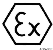
Figura 6. Etiqueta ATEX para uso em áreas classificadas
