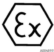
Figura 3. Etiqueta ATEX para uso em áreas classificadas
