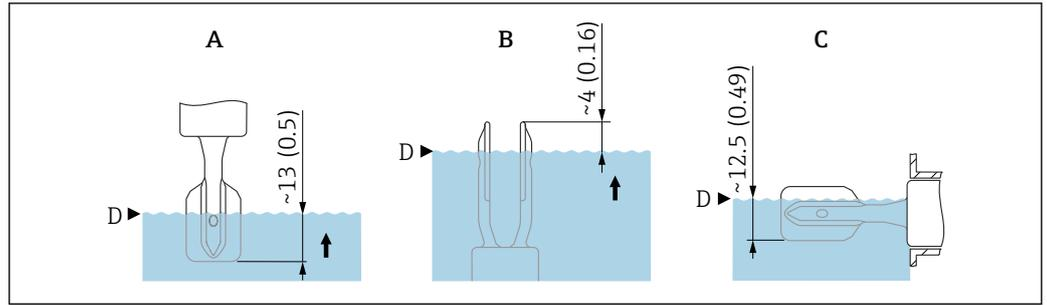
図 5 標準的なスイッチポイント。測定単位 mm (in)
