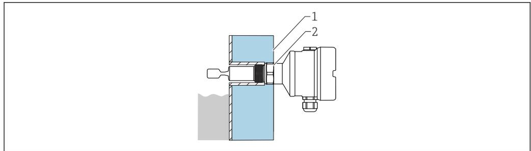
図 16 断熱材付きタンクへの設置 (例)
