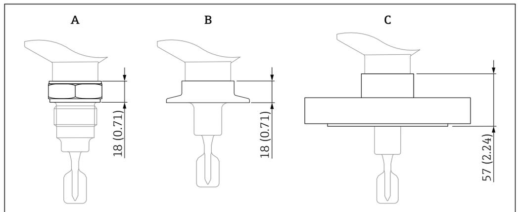
図 30 プロセス接続の最大高さ仕様。測定単位 mm (in)
