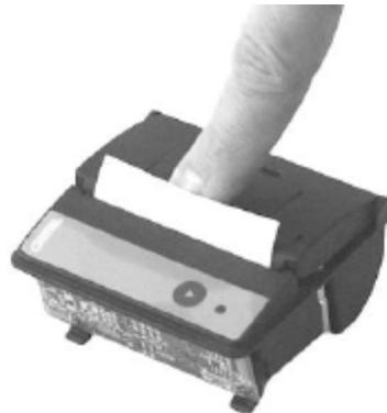
Die Abdeckung mit etwas Druck nach unten schließen.
