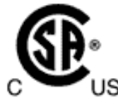
Figura 4. Etiqueta que indica que el equipo está homologado para el uso en zonas con peligro de explosión en Estados Unidos y en Canadá
