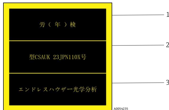
Figura 7. Etiqueta JPEX para uso en zonas con peligro de explosión
