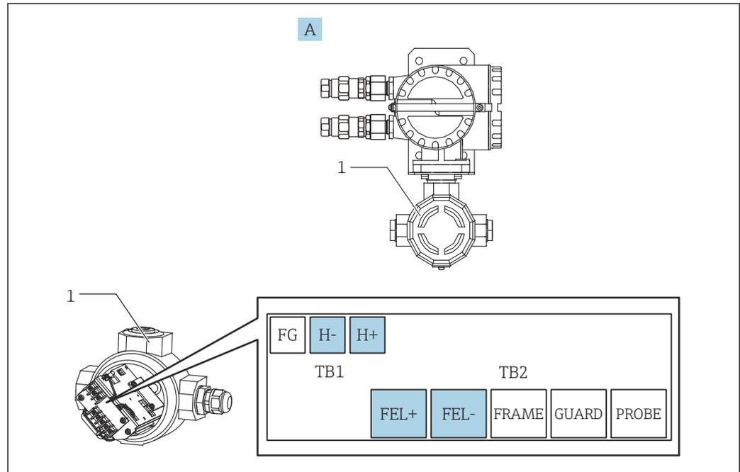
Fig. 26 Caja de terminales de seguridad intrínseca
