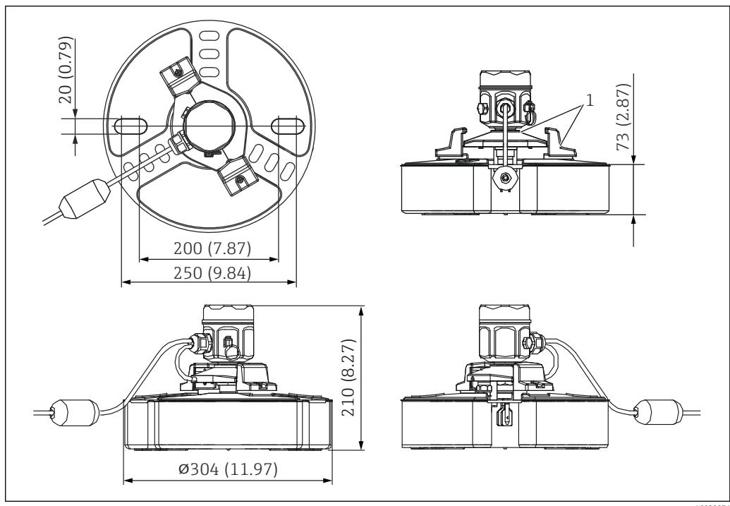
图 13 NAR300 浮子开关的外形尺寸示意图。测量单位 mm (in)
