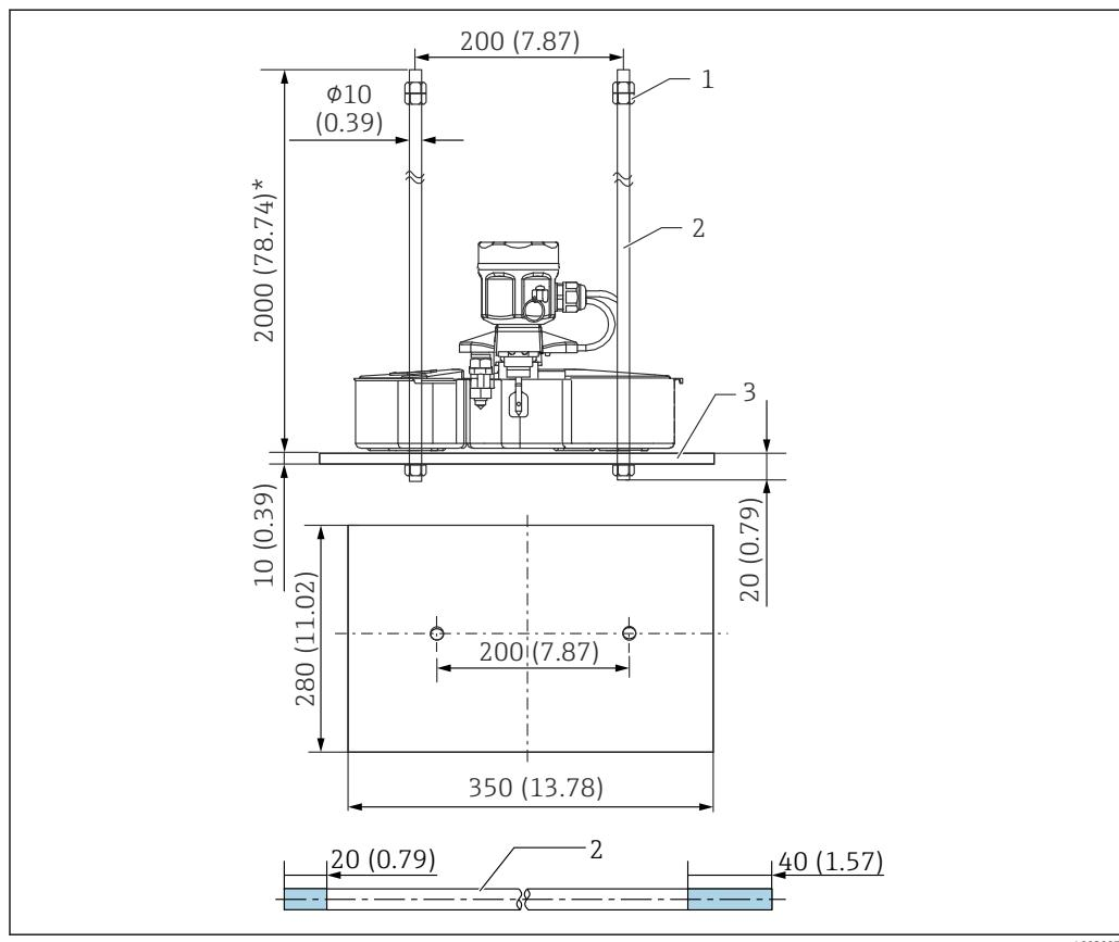
图 12 NAR300, 浮子导杆。测量单位 mm (in)
