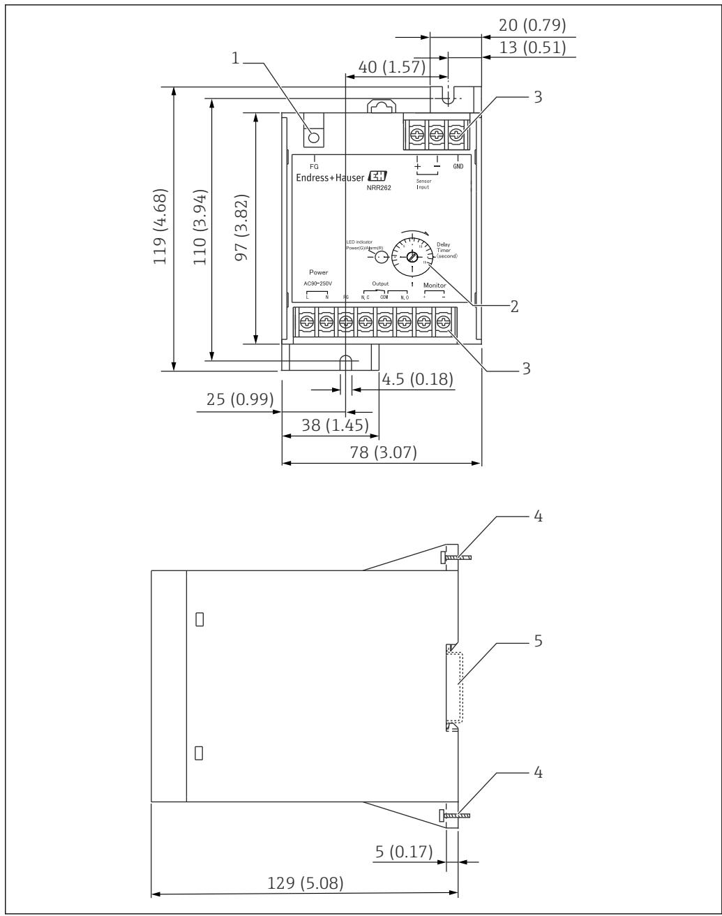
图 15 NRR262 的外形尺寸示意图。测量单位 mm (in)
