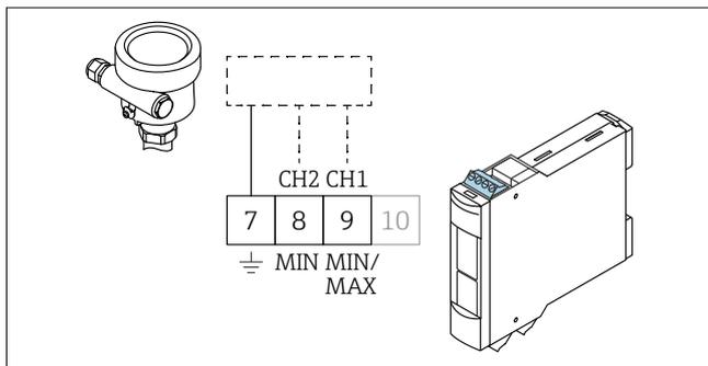
**2** Conexión de tierra de protección, MÍN y MÁX según el sensor; véase el manual del sensor
