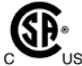
Figura 5. Etiqueta que mostra que o equipamento está aprovado para uso em áreas classificadas nos Estados Unidos e Canadá
