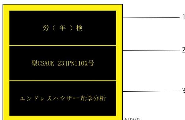
Figura 7. Etichetta JPEX per impiego in aree a rischio d'esplosione
