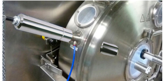
コーティング分析用のRaman Rxn-20プローブ
