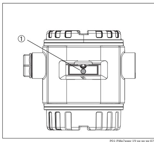
Abb. 7: Bedientasten außen, unterhalb der Schutzkappe
