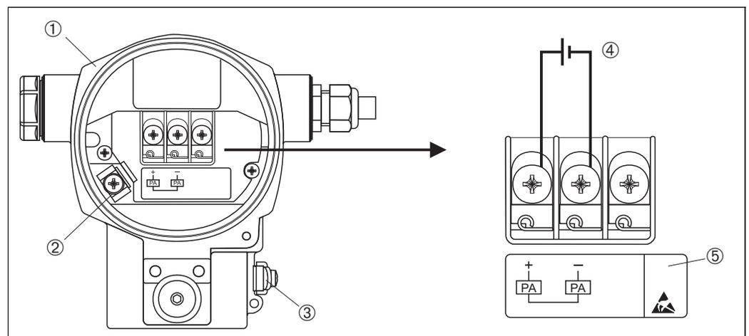
Abb. 5: Elektrischer Anschluss PROFIBUS PA
