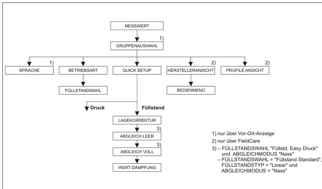
Abb. 15: Quick Setup-Menü für die Betriebsart "Füllstand"
