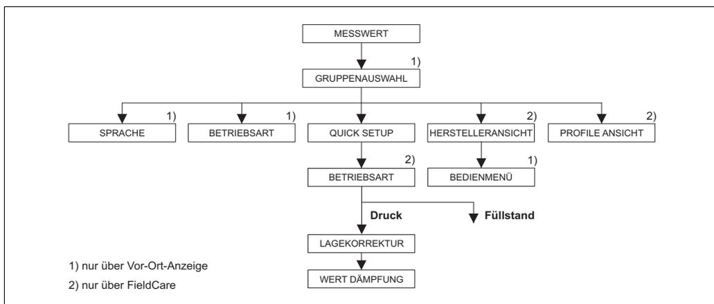
Abb. 16: Quick Setup-Menü für die Betriebsart "Druck"
