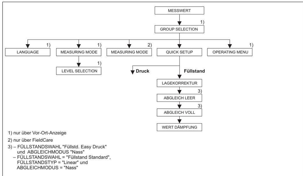
Abb. 14: Quick Setup-Menü für die Betriebsart "Füllstand"
