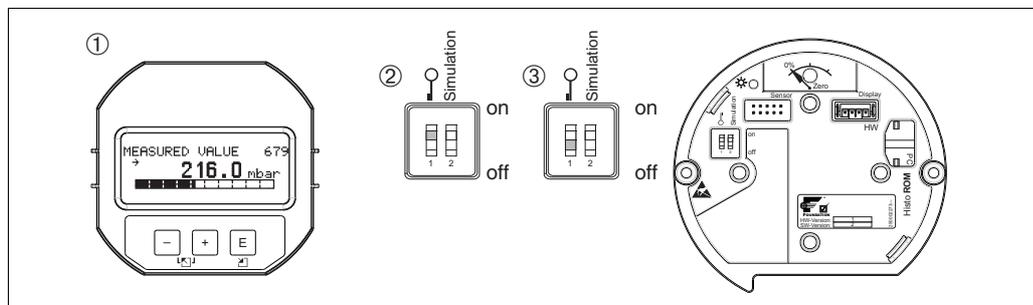
Abb. 12: Lage DIP-Schalter "Hardware-Verriegelung" auf dem Elektronikeinsatz
