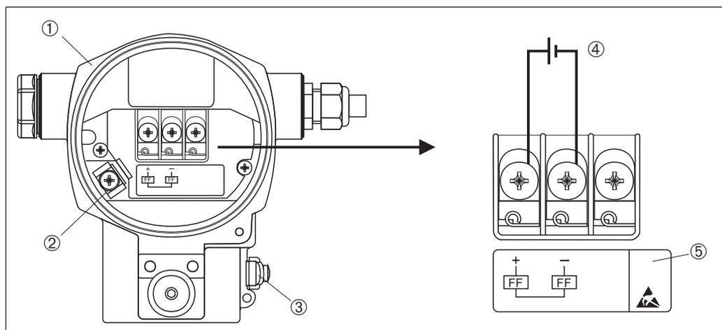
Abb. 5: Elektrischer Anschluss FOUNDATION Fieldbus
