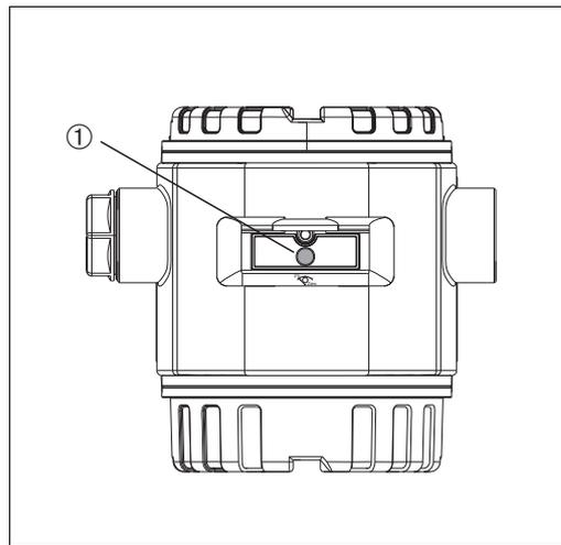
Abb. 6: Bedientasten außen, unterhalb der Schutzkappe
