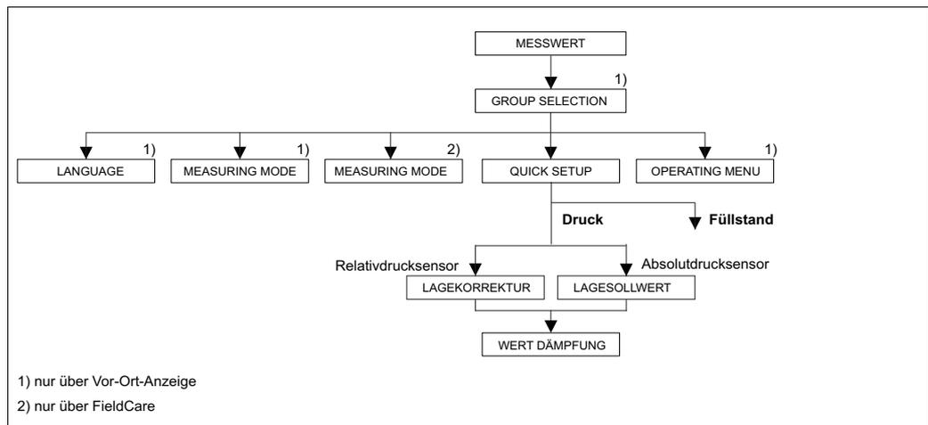
Abb. 15: Quick Setup-Menü für die Betriebsart "Druck"
