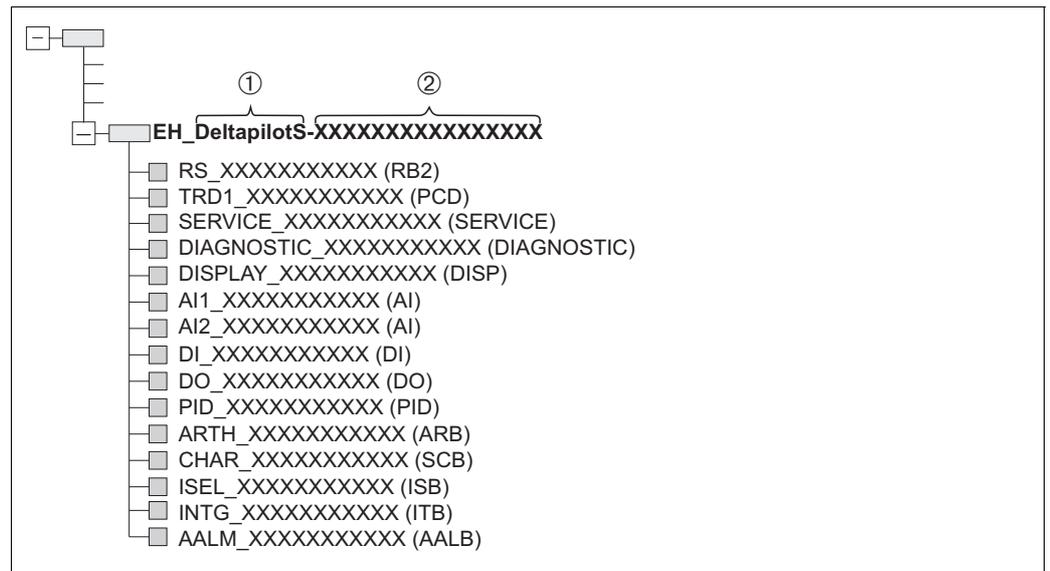
Abb. 9: Typische Darstellung des Deltapilot S in einem Konfigurationsprogramm nach dem Verbindungsaufbau
