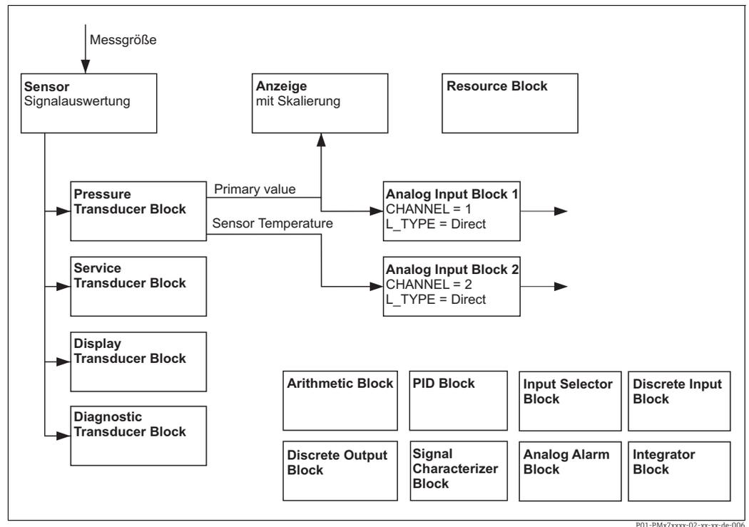
Abb. 10: Blockkonfiguration im Auslieferungszustand
