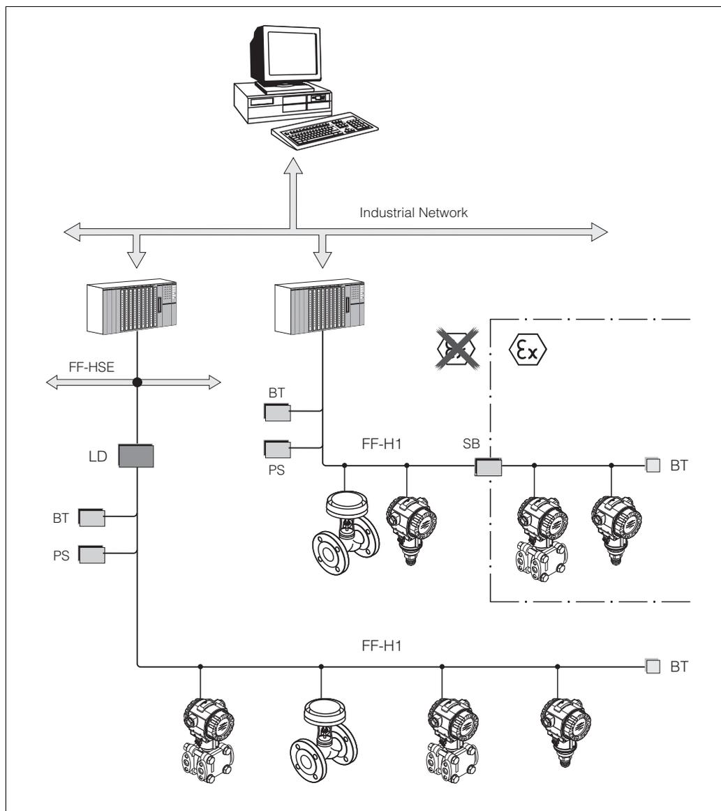
Abb. 8: Systemarchitektur FOUNDATION Fieldbus mit dazugehörigen Komponenten
