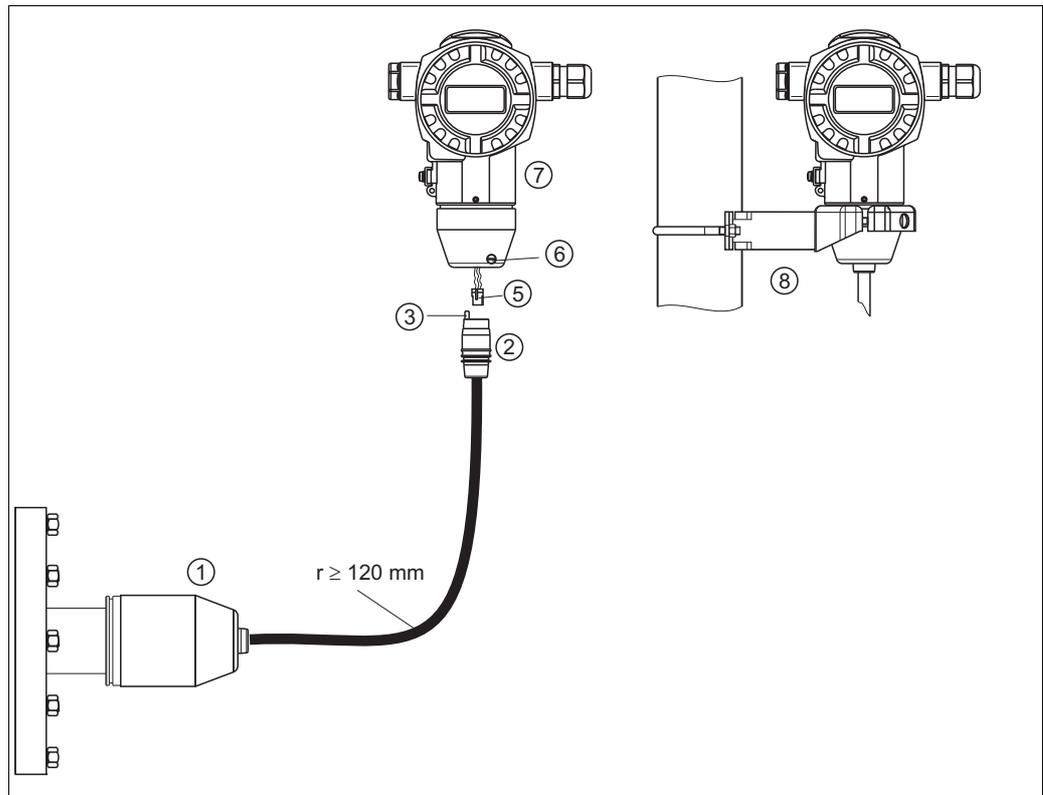
Abb. 3: Variante "Separatgehäuse"
