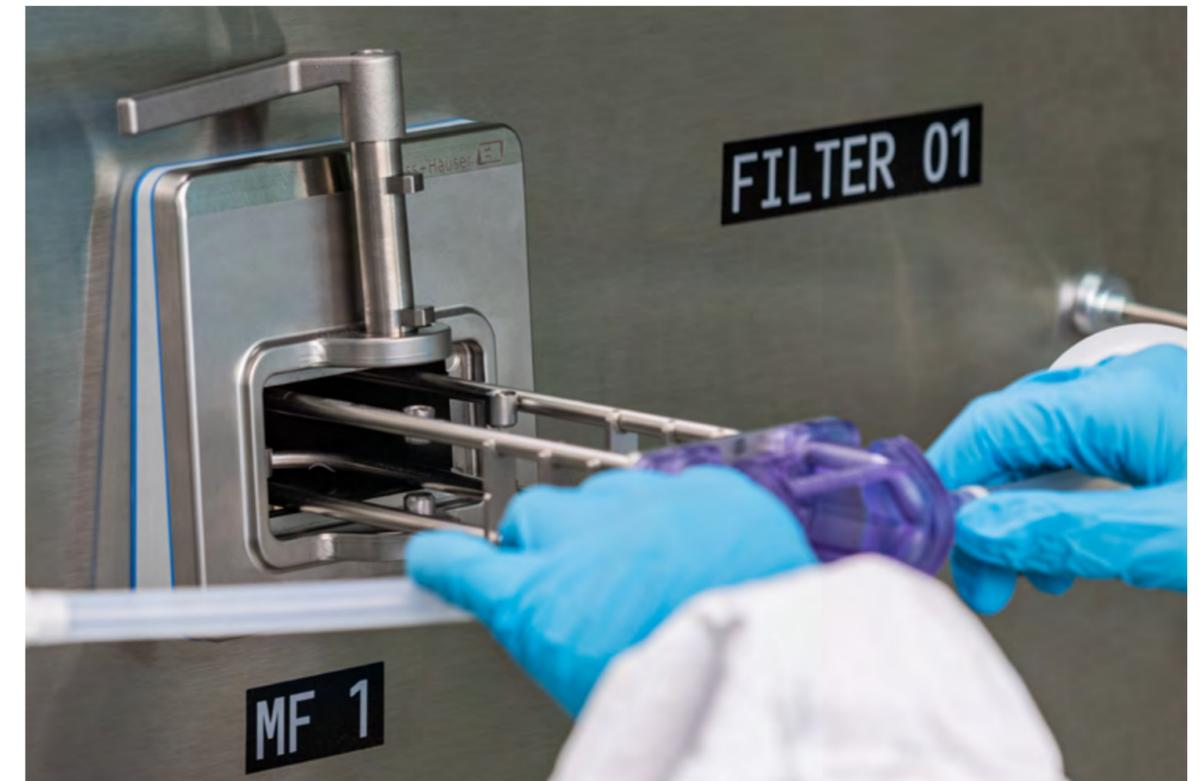
2. Anschließend kann das Einweg-Messrohr entnommen werden
