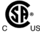
图 4. 此认证标志表示设备允许在美国和加拿大的防爆场合中使用
