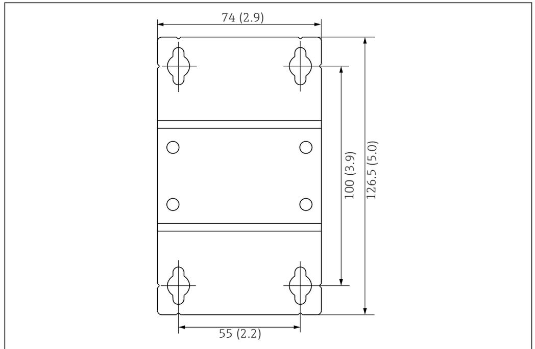
图 6 墙装架外形尺寸示意图；单位：mm (in)
