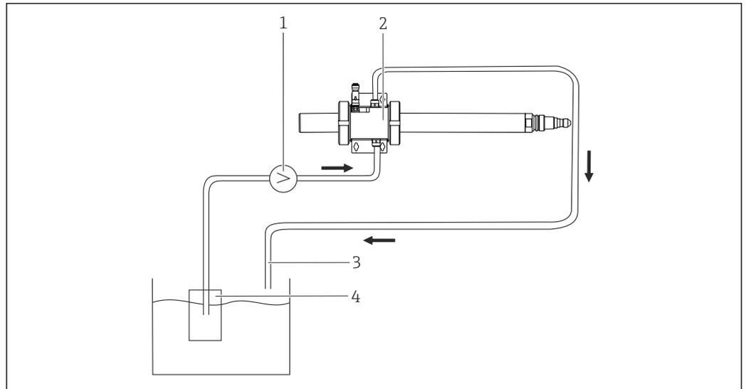
图 3 安装示意图（敞开式出水口，以 CAS80E 为例），箭头标识介质流向
