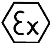
Figure 5. Label ATEX pour l'utilisation en zone explosible
