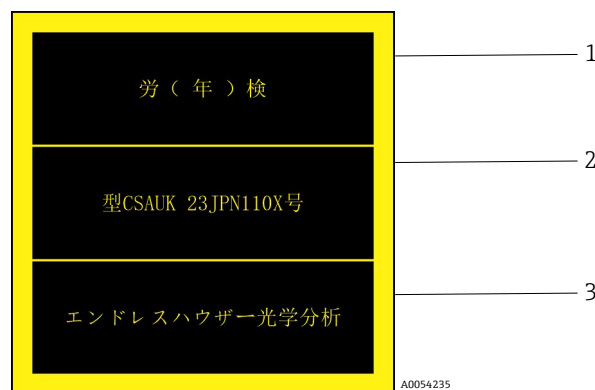
Figure 7. Label JPEX pour l'utilisation en zone explosive
