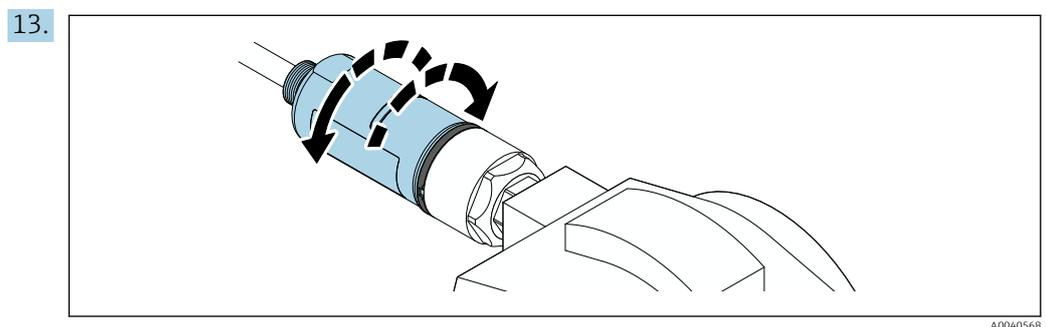
Positionner la partie inférieure du boîtier avec la fenêtre de transmission en fonction de l'architecture du réseau → 14.
