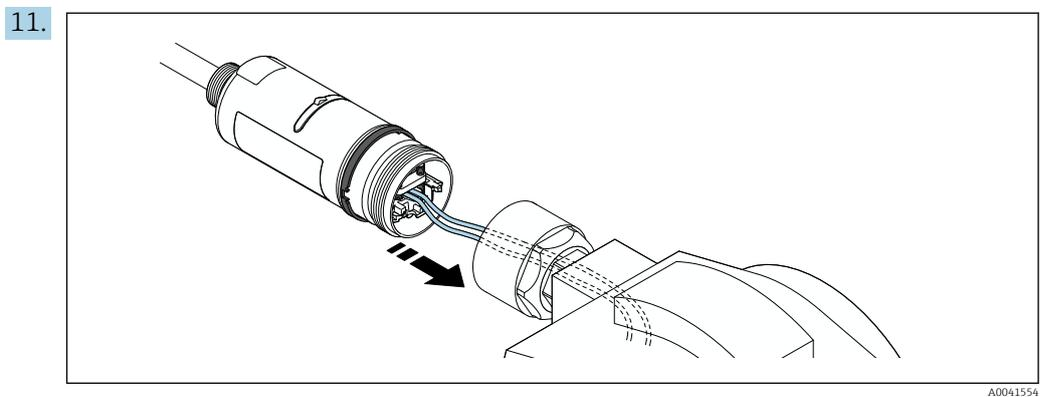
S'assurer que les fils sont de longueur suffisante pour le raccordement dans l'appareil de terrain. Raccourcir les fils dans l'appareil de terrain à la longueur requise.
