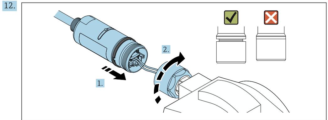
Ne pas encore serrer la partie supérieure du boîtier, afin que la partie inférieure du boîtier puisse encore être tournée.
