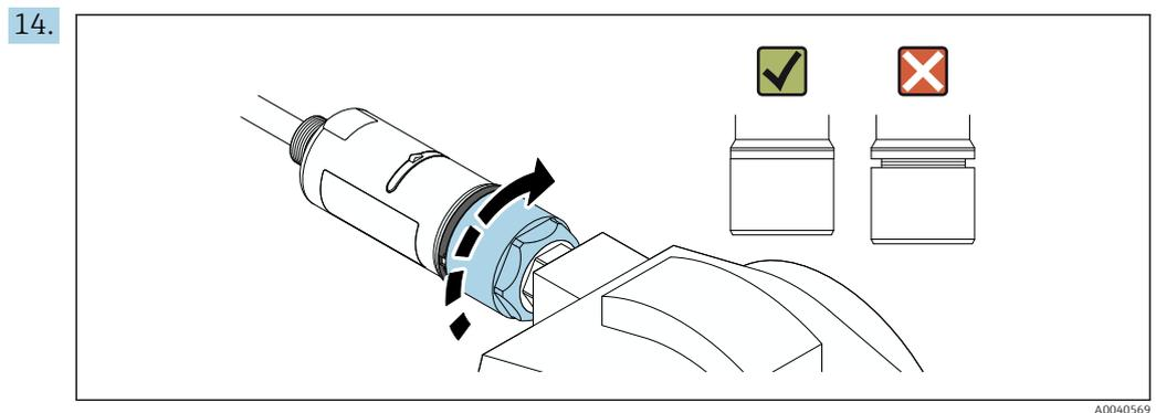
Serrer la partie supérieure du boîtier de manière à ce qu'il soit encore possible de faire tourner la bague bleue par la suite. Couple de serrage :  $5 \text{ Nm} \pm 0,05 \text{ Nm}$
