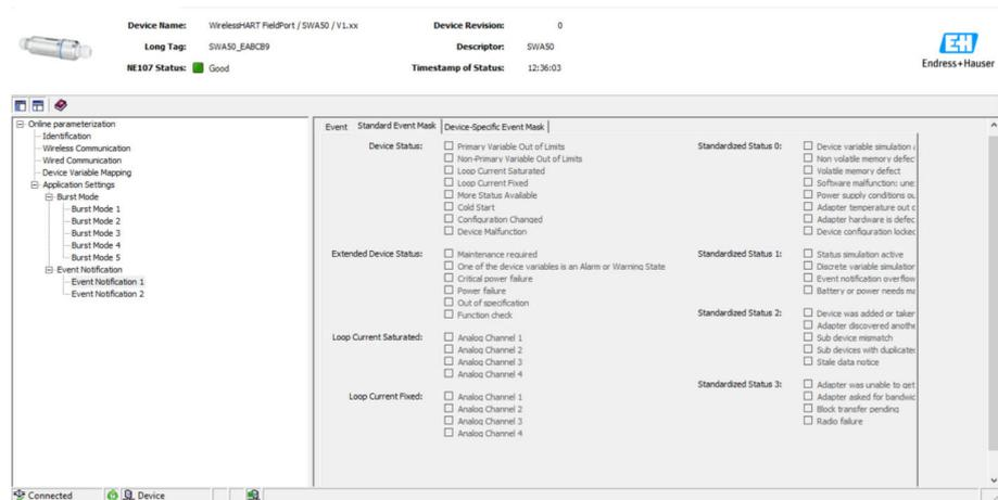
6. Activer les notifications d'événement souhaitées dans l'onglet "Device-Specific Event Mask". Pour cela, sélectionner la case à cocher située devant l'événement concerné. Il est possible de sélectionner plusieurs notifications. Respecter les instructions du manuel de mise en service relatif à l'appareil sélectionné dans le paramètre "Device Index".
