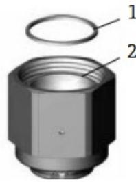
Abb. 79. Dichtung auf der Dichtungsfläche der Haube zentrieren
