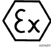
Abbildung 3. ATEX-Kennzeichnung für den Einsatz in explosionsgefährdeten Bereichen
