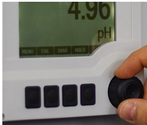
38 Bedienung über externes, optionales Display
